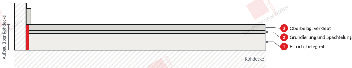
Oberbodenaufbau auf belegreifem Estrich – schematisch, nicht maßstäblich.
