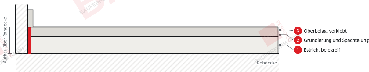
Oberbodenaufbau auf belegreifem Estrich – schematisch, nicht maßstäblich.
