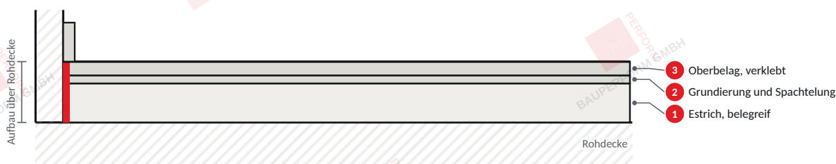
Oberbodenaufbau auf belegreifem Estrich – schematisch, nicht maßstäblich.
